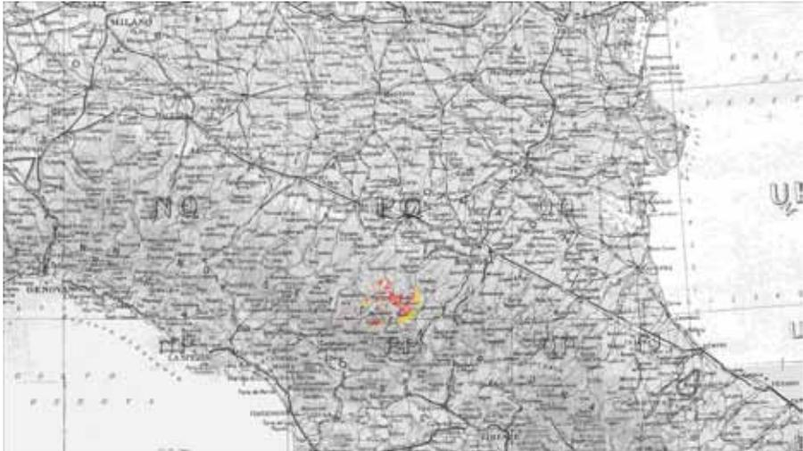
*Fig. 56 - Copertura canale 28 in polarizzazione orizzontale*
