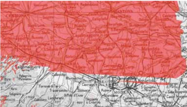
Fig. 116 - Area di interferenza dell'impianto di Monte Penice ai danni della copertura di Canate (rapporto di protezione 30 dB)
