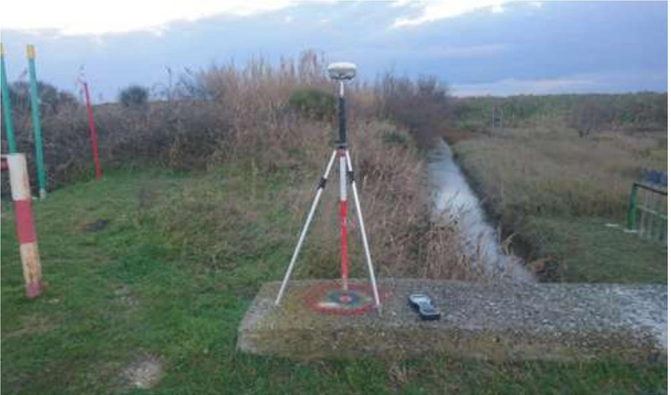
FIGURA 35 Rete Geodetica Costiera: posizionamento della stazione master su un vertice.
