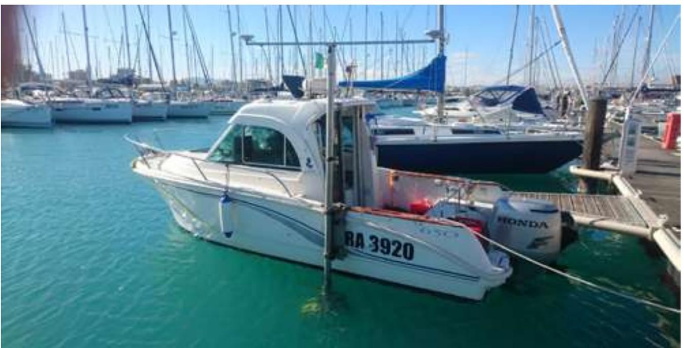
FIGURA 39 Sistema integrato per rilievo multibeam.
