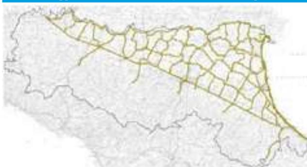
A questa rete si collegano altre reti di livellazione appartenenti al Catasto, a Enti locali e a Istituti di ricerca. È attualmente in fase di svolgimento un importante progetto di completa rimisura delle linee esistenti e contemporanea istituzione di nuove linee di raffittimento che porteranno a un totale di oltre 20.000 capisaldi.
