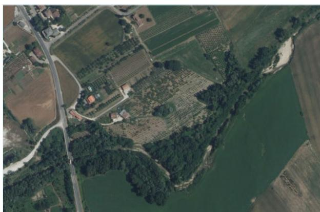
Figura 6 - Ortofotocarta satellitare 2014 area di intervento fiume Uso tratto collinare del fiume Uso eseguito negli anni 1995-1997. Trattasi di due tratti fluviali in località S.Vito di Rimini e Chiesa di Camerano (Poggio Berni- Santarcangelo): si è provveduto all'ampliamento dell'alveo fluviale che era stato ristretto da argini golenali di modesta entità (1,5 metri di media) e che fungevano da sola "protezione" dei campi agricoli limitrofi.
