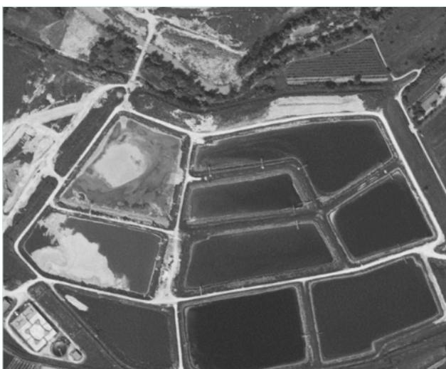
Figura 7 - Vasche zuccherificio SFIR scavi apertura setti e sfioratore
