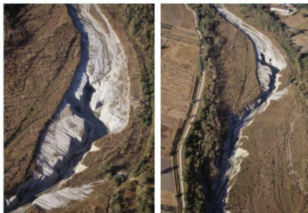
Figura 9 - Visione dall'alto dell'incisione dell'alveo del Marecchia nella formazione delle argille del Pliocene
