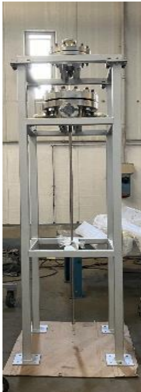
Prova di tubi a baionetta per il circuito di evacuazione del calore residuo
